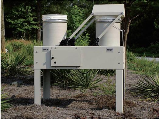
酸雨采样器 (A.P.S.) 可用于精确分离和收集降水、颗粒物总量,适用于实验室分析 pH、电导率及其他应用。
