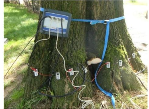
PiCUS TreeTronic 电阻断面成像仪通过检测树木区域的电流或电阻计算并绘制相应的相对电阻图，该图象表示树木的电阻变化，简称 EIT (Electrical Impedance Tomogram)。根据不同材质对应不同的电阻值，确定木材缺陷情况。由于电阻成像检测法是根据木材腐朽阻抗的不同检测木材内部腐朽的，而对应于某种腐朽的阻抗的变化在一个很大的范围，所以断层扫描的过程变得非常复杂。与超声断层检测仪 (SoT) 结合使用时，EIT 可提供更多信息，如分析损伤类型，发现空洞和感染病害的树木。
